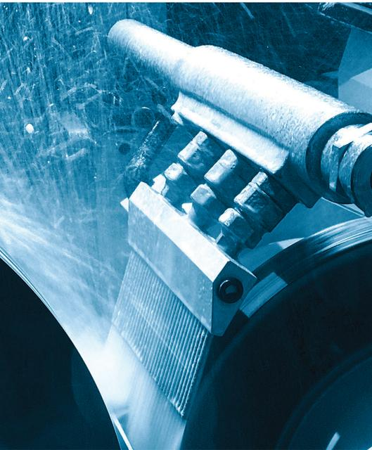
2 Auf der APG können Scheiben mit einem Durchmesser bis zu 500 mm und einer Breite von 250 mm montiert werden
