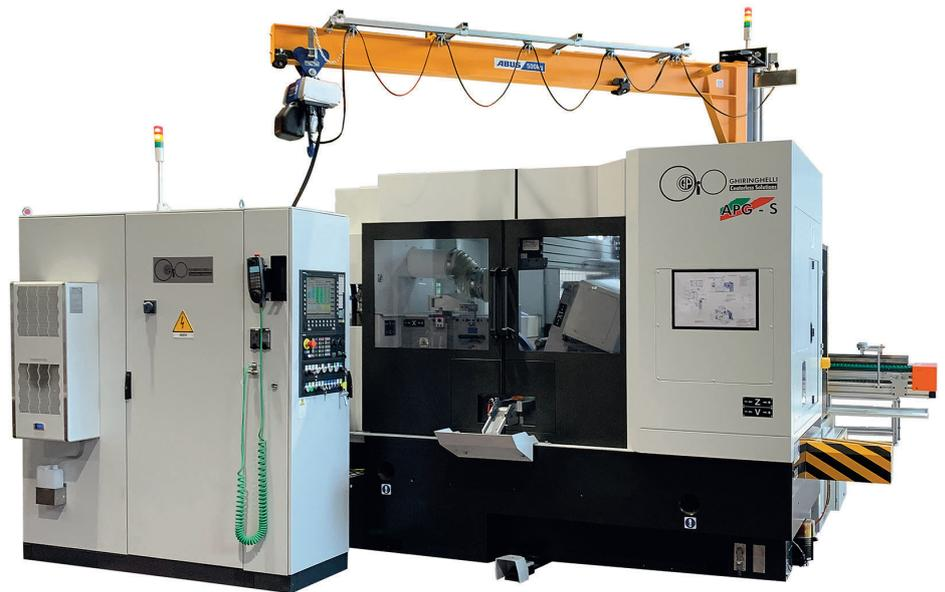
1 Die neue APG ist für die optimale Nutzung des spitzenlosen Rundschleifprozesses bei hoher Schnittgeschwindigkeit bis zu 120 m/s konzipiert © Ghiringhelli
